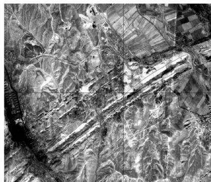
图 1 呈线状、带状延伸的塌陷影像图
