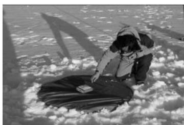
图 2 测量标志及 GPS 点位测量
